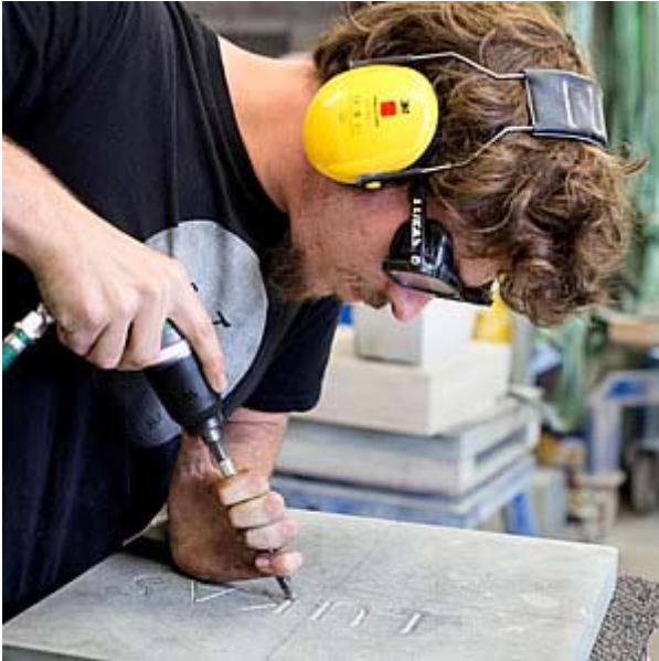
Azubi Lukas-Kayron Schunke haut die Buchstaben seines Namens mit einem Druckluftmeißel in einen Stein.
